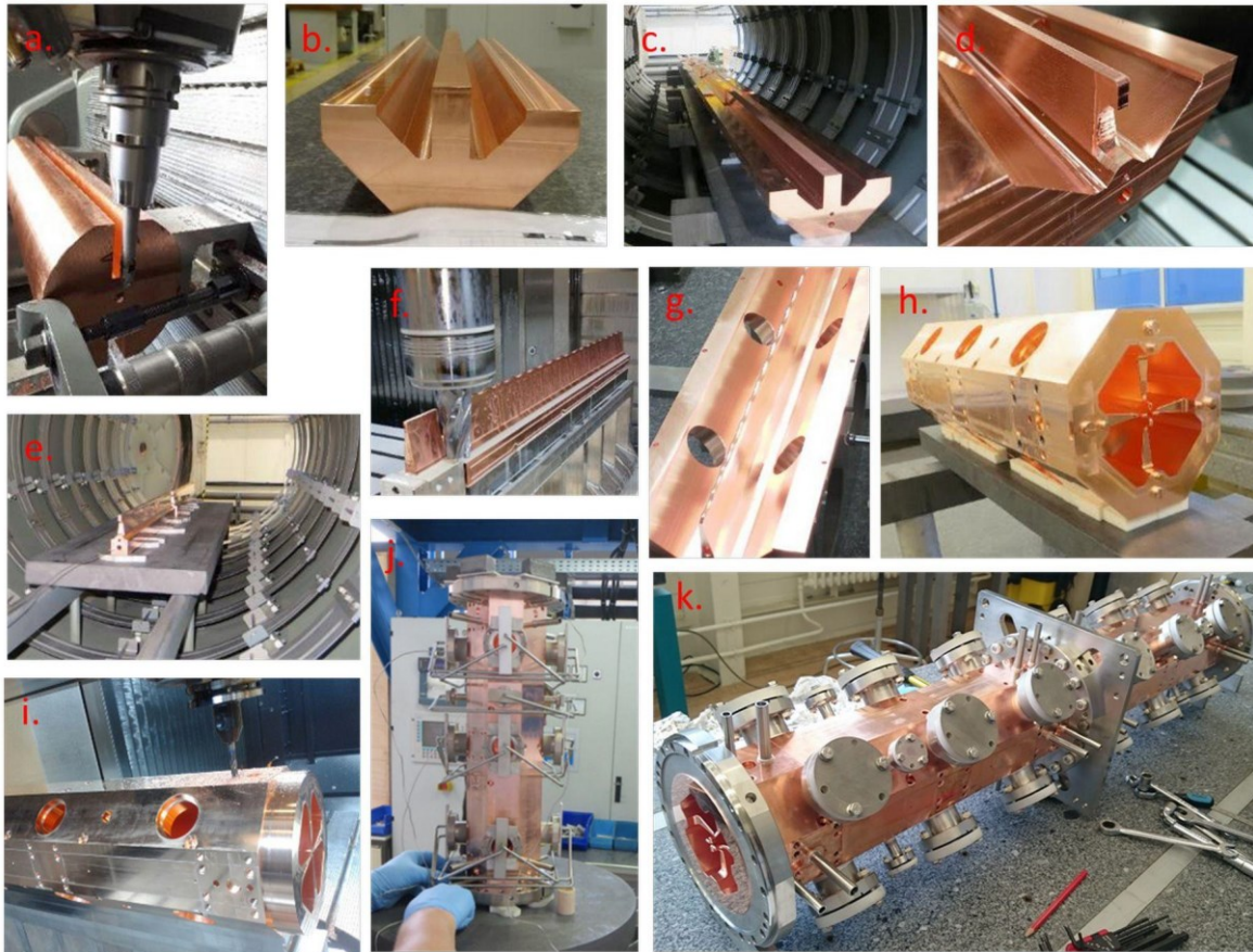
Figura 1: Fasi di produzione del PIXE-RFQ: a.: Lavorazione del materiale grezzo; b.: Lavorazione pre-grossolana; c.: Primo trattamento termico; d.: Lavorazione grezza; e.: Secondo trattamento termico; f.: Pre-finitura; g.: Trattamento termico finale e finitura; h.: Prima brasatura in vuoto; i.: Lavorazione dopo la brasatura; j.: Seconda brasatura in vuoto; k.: Lavorazione finale e assemblaggio del RFQ.
